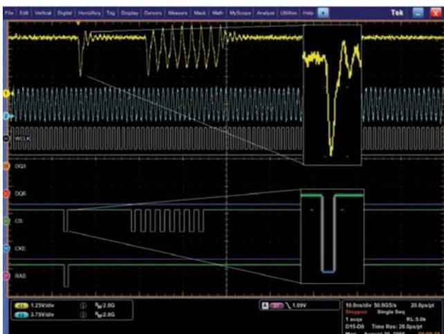
图 21. iCapture 显示了芯片选择线的模拟和数字联合观测
