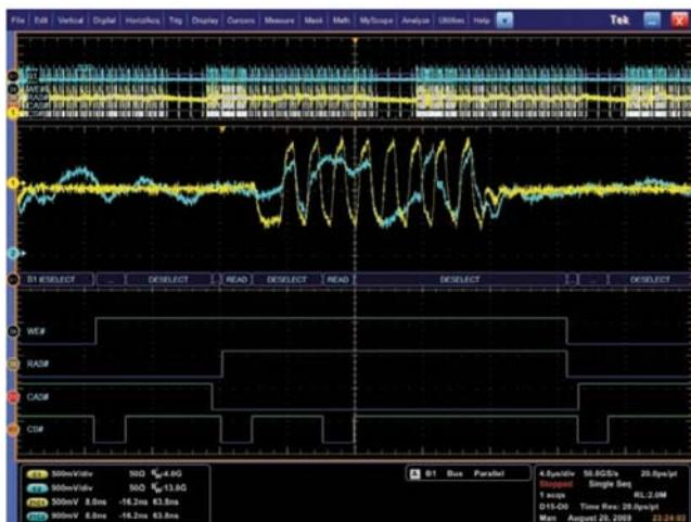
图 11. MSO70000 DDR3 命令总线解码
