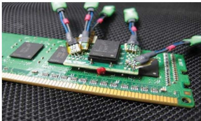
图 5. 带焊接前端的转接板，被测信号的眼图
