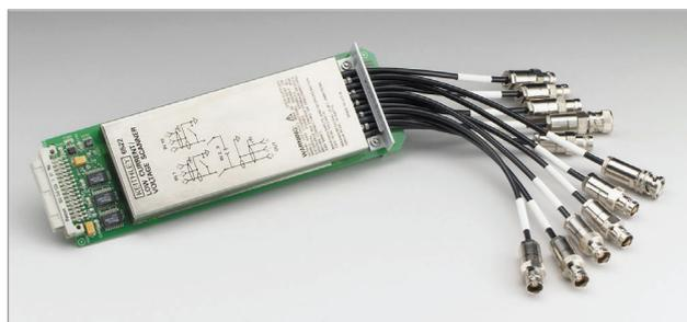
6522 电压 / 低电流扫描卡
