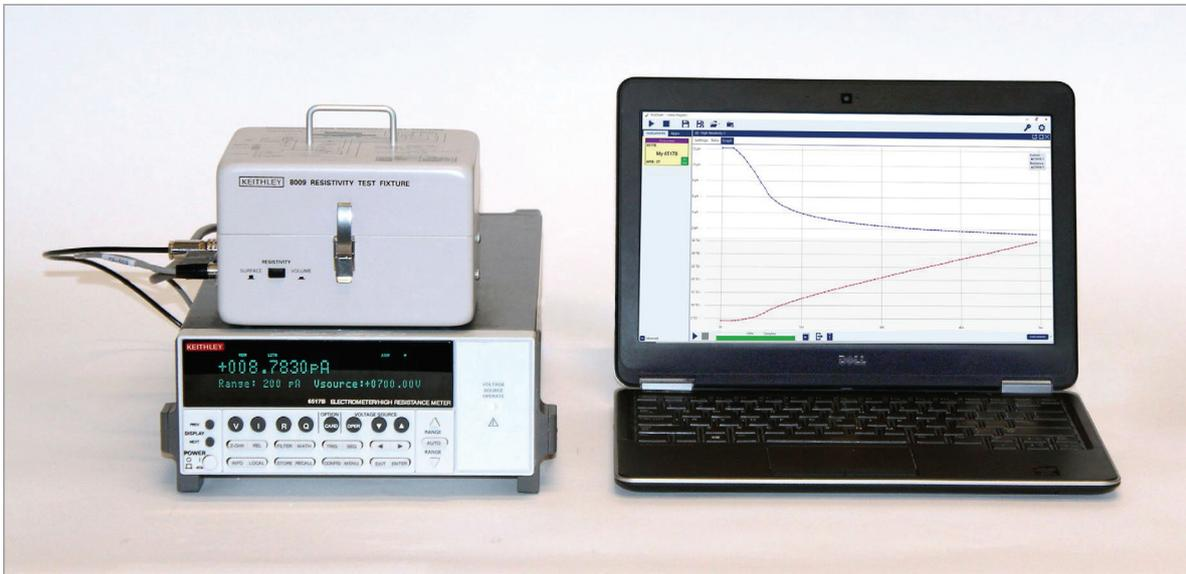
ASTM-D257 标准高电阻率测试系统及 6517B 静电计、8009 电阻率测试夹具和 KickStart 高电阻率应用。
