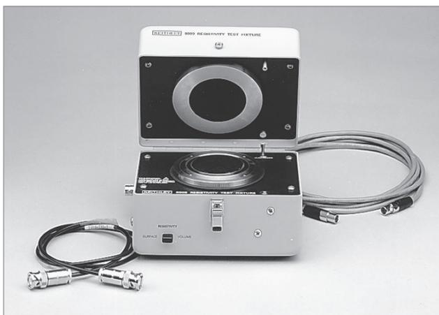
8009 电阻率测试夹具满足美国测试材料协会 (ASTM) D257 标准规定的绝缘材料 DC 电阻或电导标准测试方法。8009 与 6517B 相结合，为进行优质安全的电阻率测量提供了完整的系统。8009 带有 6517B-ILC-3 安全互锁电缆、7078-TRX-3 三同轴到三同轴电缆及 8607 1 kV 源电压香蕉插口成套电缆。
