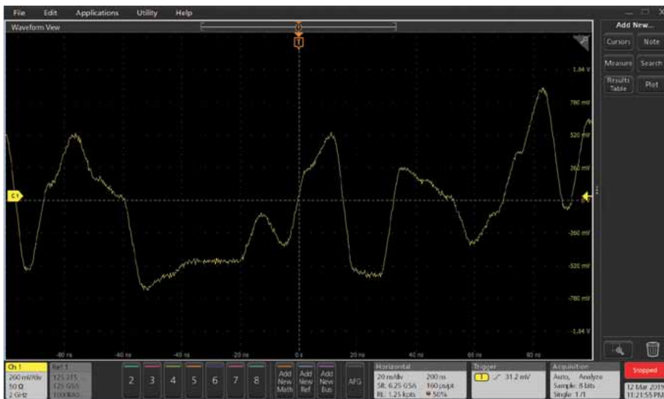
图 4. 1000BASE-T 测试模式 4 发送一个加扰的信号。
