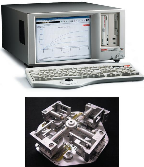
图 1: Keithley 的 4200-SCS 半导体表征系统和 Zyvex S100 纳米驱动器
